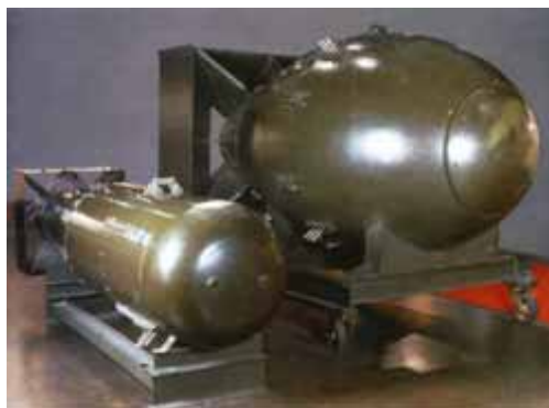
Рис. 2.9. Американские атомные бомбы «Литтл бой» («Малыш») пушечного типа (мощностью 21 кт ТНТ) на основе урана-235 и «Фэт Мэн» («Толстяк») с использованием принципа имплозии на основе плутония-239 (мощностью 21 кт ТНТ), сброшенные на японские города Хиросима и Нагасаки
