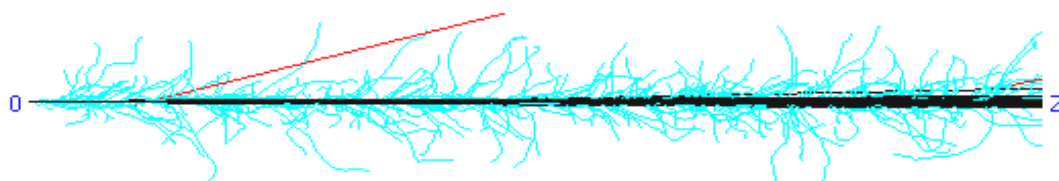
Рис. П1.4. Траектории первичных протонов ( T_0 = 100 МэВ) и вторичных электронов в воде
