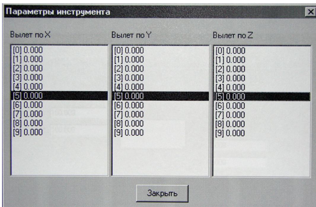
Рис. 14. Настройки вылетов инструмента
