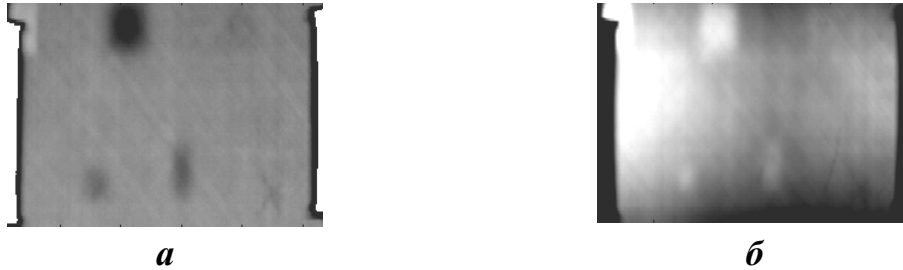
Рис. 3.15. Применение Фурье-анализа к исходной последовательности: а – изображение фазы на 3 частоте; б – изображение модуля амплитуды для нулевой частоты
