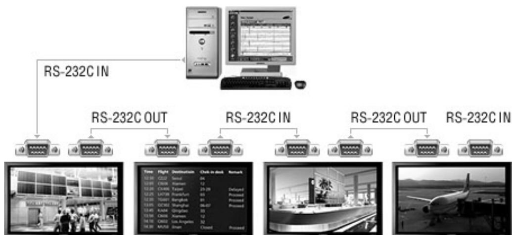
Рис. 1.2. Архитектура канала управления LCD дисплеями
