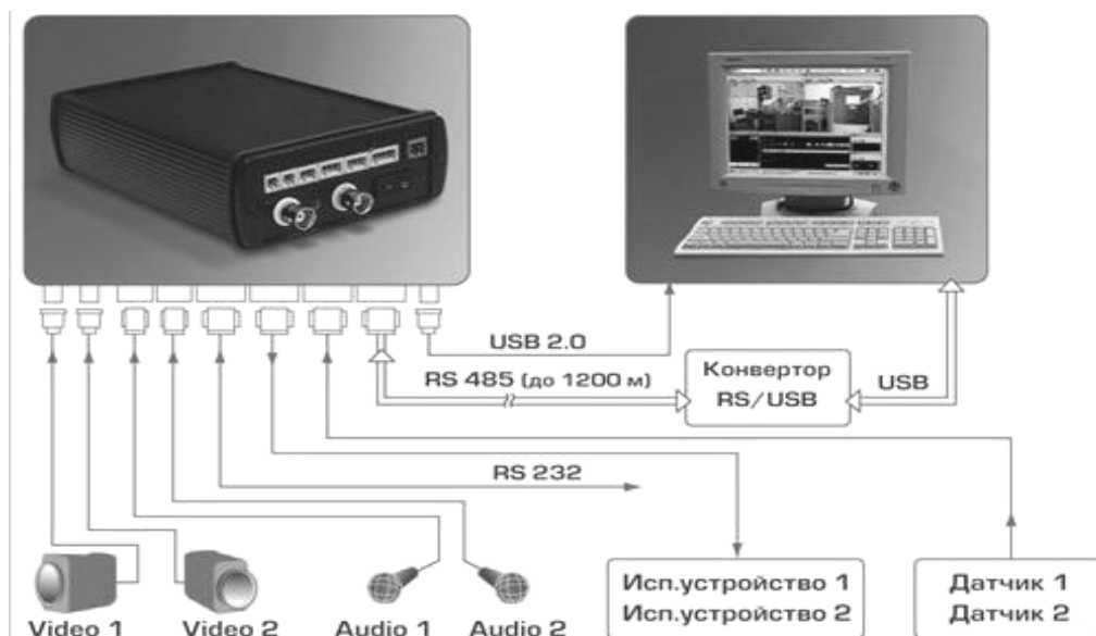
Рис. 1.7. Структура видео-аудиосервера «ОКО-Архив-Лайт»
