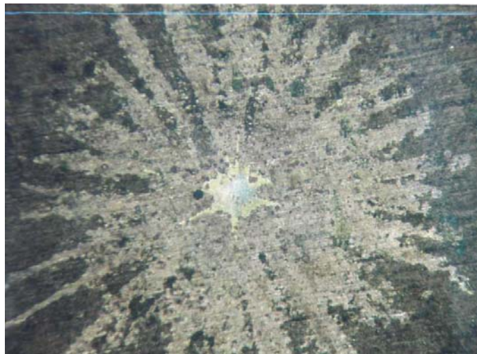
Рис. 3.5. Автограф электронного пучка на поверхности латуни
