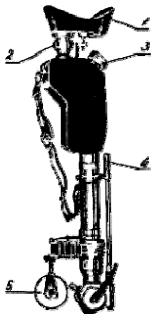
Рис. 29. Переносной стилоскоп СЛП-1: 1 – налобник; 2 – окуляр; 3 – маховичок со шкалой; 4 – маховичок разворота поворотной призмы; 5 – постоянный электрод
