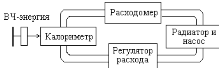
Рис. 1.1.5.30. Структурная схема проточного калориметрического преобразователя
