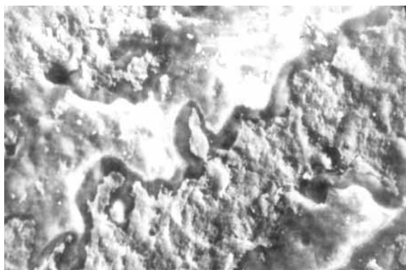
Рис. 6.42. Поверхность титановой пленки на пластине нитрида бора после 10 мин электролиза с плотностью тока 100 \text{ mA}/\text{cm}^2 , электролит \text{LiOH}+\text{H}_2\text{O} . На поверхности видны многочисленные островковые образования, вызванные разрушением части титанового покрытия. Увеличение 1000
