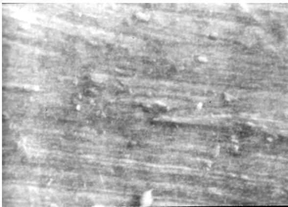
Рис. 6.34. Поверхность титана до насыщения водородом. Видны следы механической полировки. Увеличение 1500
