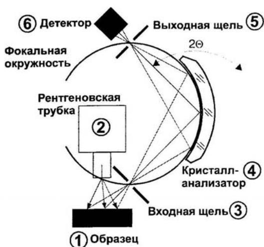
Рис. 3. Функциональная схема спектрометра
