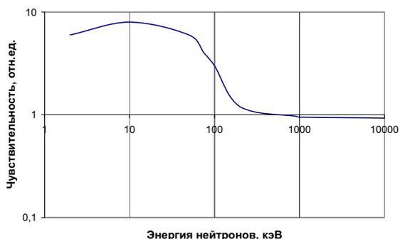
Рис. 1. Зависимость чувствительности радиометра-дозиметра с блоком детектирования БДКН-03Р + «защита» + «замедлитель» от энергии нейтронов
