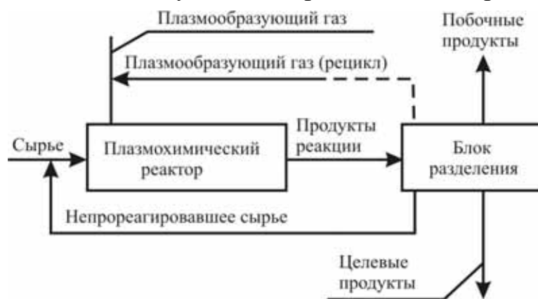
Рис. 32. Схема совместной работы плазмохимического реактора и блока разделения
