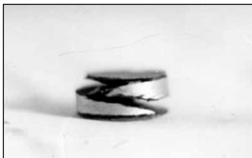
Рис. 2.7. Образец из нанопорошка алюминия после спекания с саморазогревом
