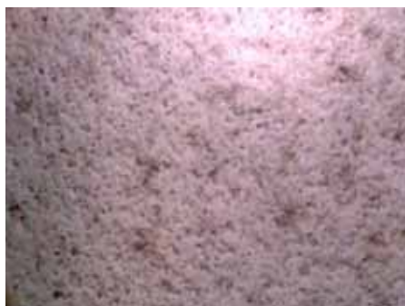
Рис. 5.77. Фильтрующий стекло-кристаллический материал (размер зерна 100 мкм) с добавкой 2,5 % НП алюминия сожженного. Температура обжига 1400 °С, выдержка 0,5 ч. Увеличение 60
