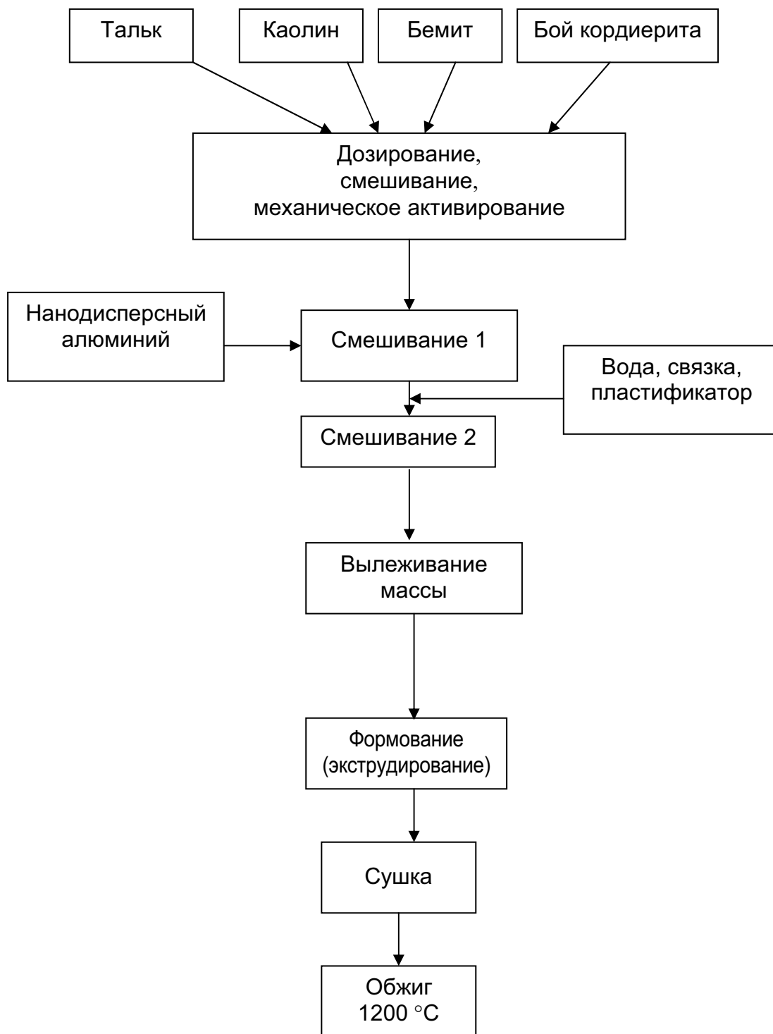
Рис. 6.1. Технологическая схема 1 изготовления кордиеритовых блочных носителей катализаторов с применением металлического порошка
