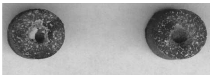
Рис. 6.13. Образцы с металлургическим шлаком после нагрева на воздухе при 1500 °С (слева – с добавкой ПАП-2, справа – нанодисперсного алюминия)
