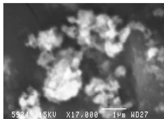
Рис. 5.13. Исходный порошок \text{SiO}_2 -аморфный (электронный сканирующий микроскоп; увеличение – 5000 и 17000)
