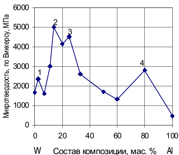
Рис. 2.8. Микротвёрдость спеченных вольфрамо-алюминиевых порошковых композиций. Атомное соотношение W/Al в точках: 1 – 5/1, 2 – 1/1, 3 – 1/2, 4 – 1/20
