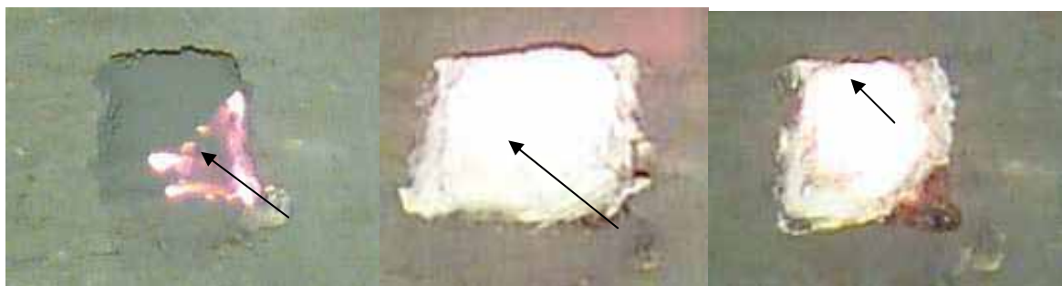
Рис. 5.2. Фотографии горящего в воздухе свободнонасыпанного порошка электровзрывного алюминия:
