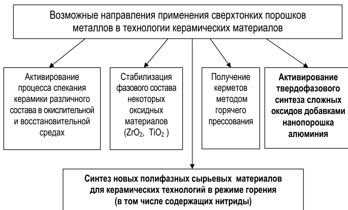
Рис. 6.14. Схема вариантов применения нанодисперсного алюминия в технологии керамики
