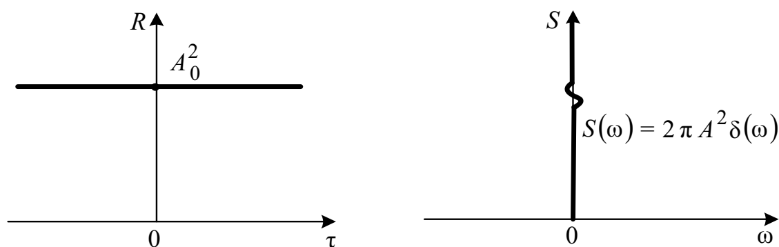
Рис. 3.10. Корреляционная функция и спектральная плотность постоянного по уровню сигнала
