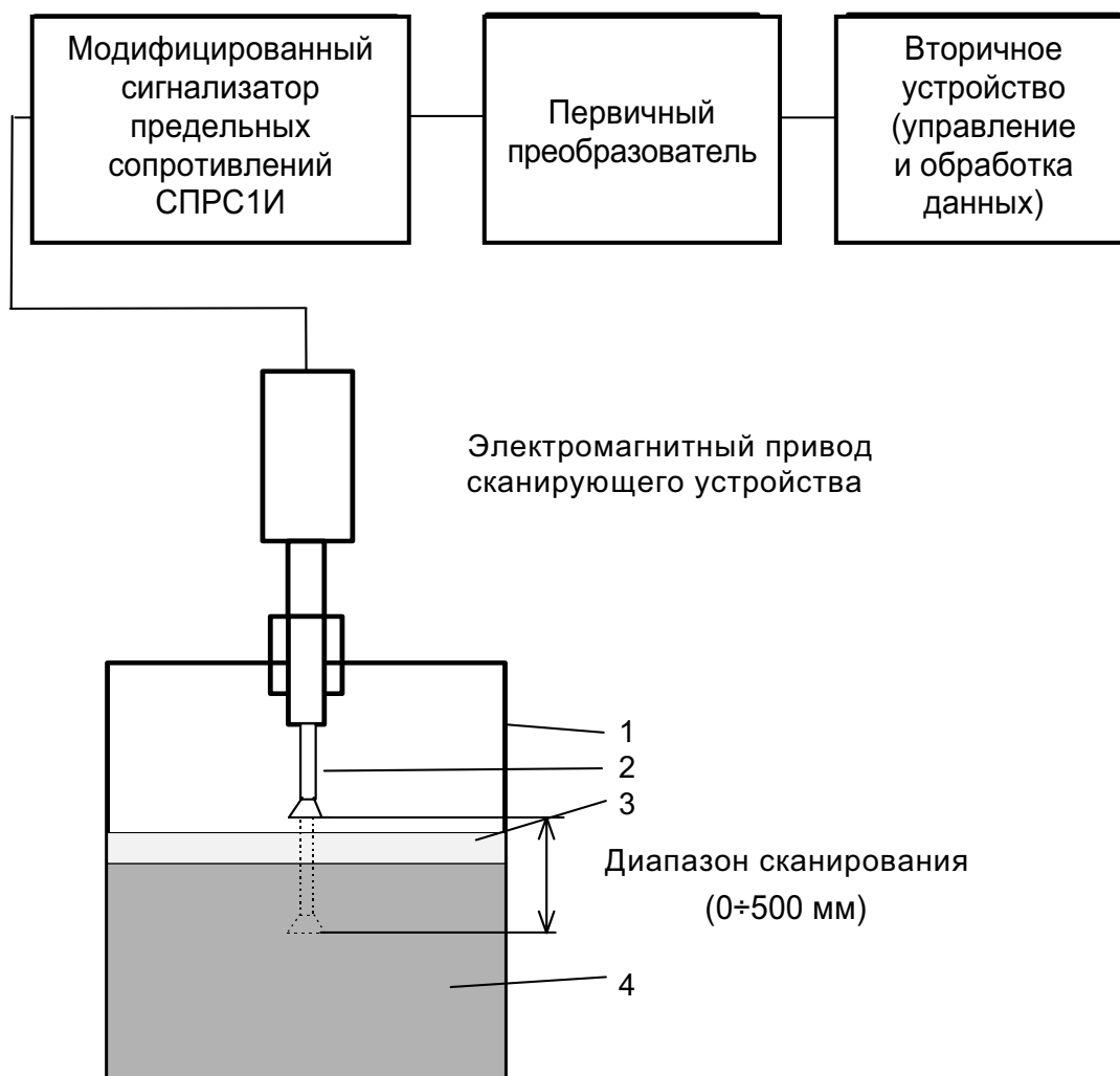
Рис. 2.12. Схема измерения толщины слоя органической фазы в технологической цистерне на основе сканирующего устройства «Градиент»: 1 – цистерна; 2 – электрод; 3 – слой органической фазы; 4 – водная фаза
