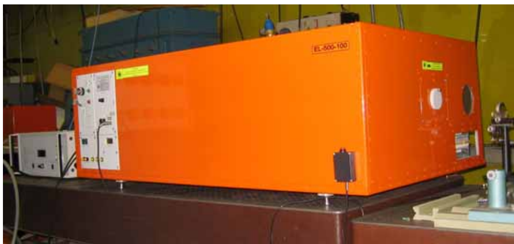
Рис. 1.1.8. Внешний вид эксимерного лазера EL-500-100: E = 0,5 Дж, f = 100 Гц, \lambda = 308 нм
