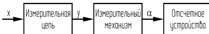
Рис. 3.1. Структурная схема электроизмерительного прибора
