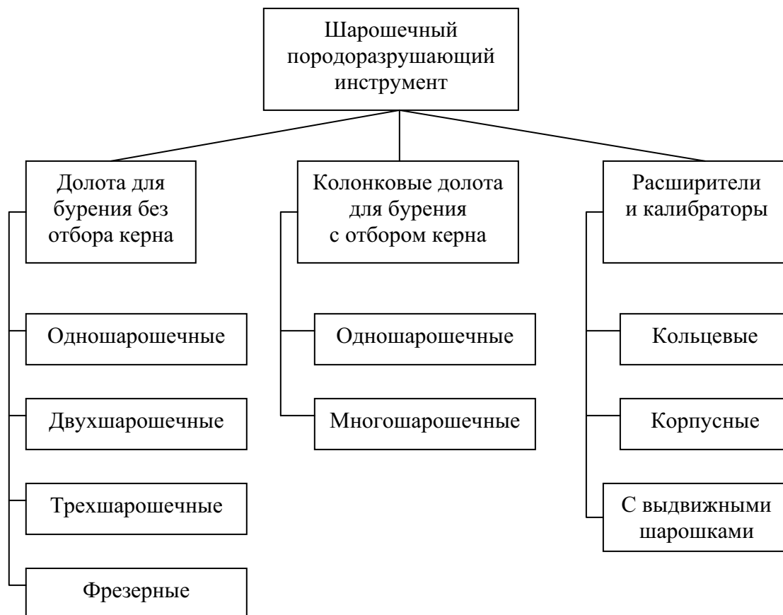
Рис. 1.4. Шарошечный породоразрушающий инструмент
