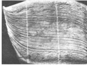
Рис. 9.27. Морщины на поверхности заготовки
