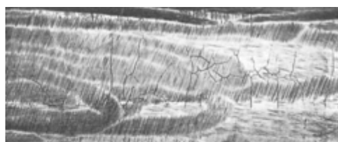
Рис. 9.42. Схема прутка стали с сеткой шлифовочных трещин
