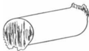
Рис. 9.33. Схематическое изображение заусенца
