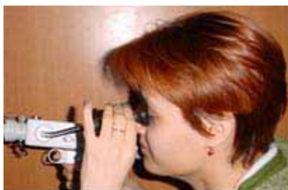
Рис. 11.11. Наводка окуляра на резкость
