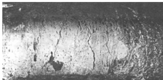
Рис. 9.17. Слиток сплава 20НГ с грубыми рванинами, образовавшимся при первых ударах молота
