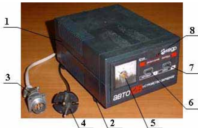
Рис. 11.9. Зарядное устройство «КЕДР-АВТО»: 1 – корпус; 2 – ножки; 3 – кабельная вилка; 4 – вилка сетевого шнура сети 220 В, 50 Гц; 5 – стрелочный индикатор тока (амперметр); 6 – кнопка режима «АВТОМАТ»; 7 – кнопка режима «ЦИКЛ»; 8 – световой индикатор
