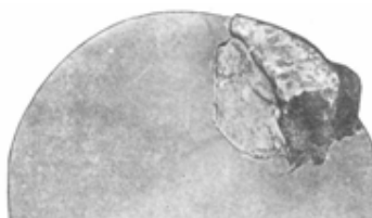
Рис. 9.39. Макрошлиф прутка, показанного на рис. 9.38
