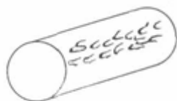
Рис. 9.18. Схематическое изображение прокатных плен на прутке
