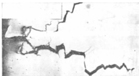
Рис. 9.44. Микрошлиф сплава ХН68ВКТЮ с шлифовочной трещиной
