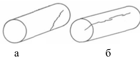
Рис. 9.13. Схемы трещин напряжения на прутках стали: а – единичная трещина; б – прерывистая продольная трещина
