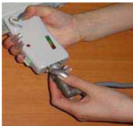
Рис. 11.14. Подключение эндоскопа к аккумуляторной батарее
