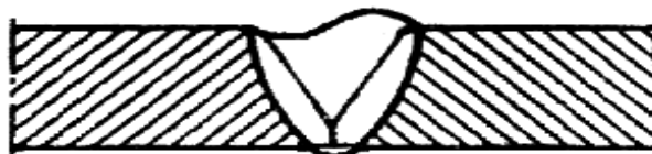
Рис. 7.26. Не полностью заполненная разделка кромок
