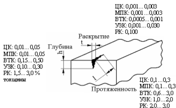
Рис. 1. Минимальные размеры обнаруживаемых дефектов
