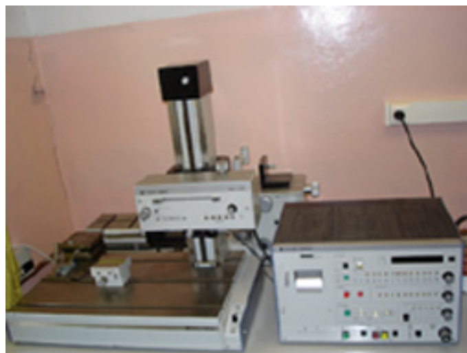
Рис. 4. Фотография профилометра-профилографа «Talysurf 5м»
