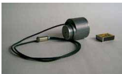
Рис. 2.82. Акустический преобразователь: (патент России № 2249186 от 27.03.2005 г.)
