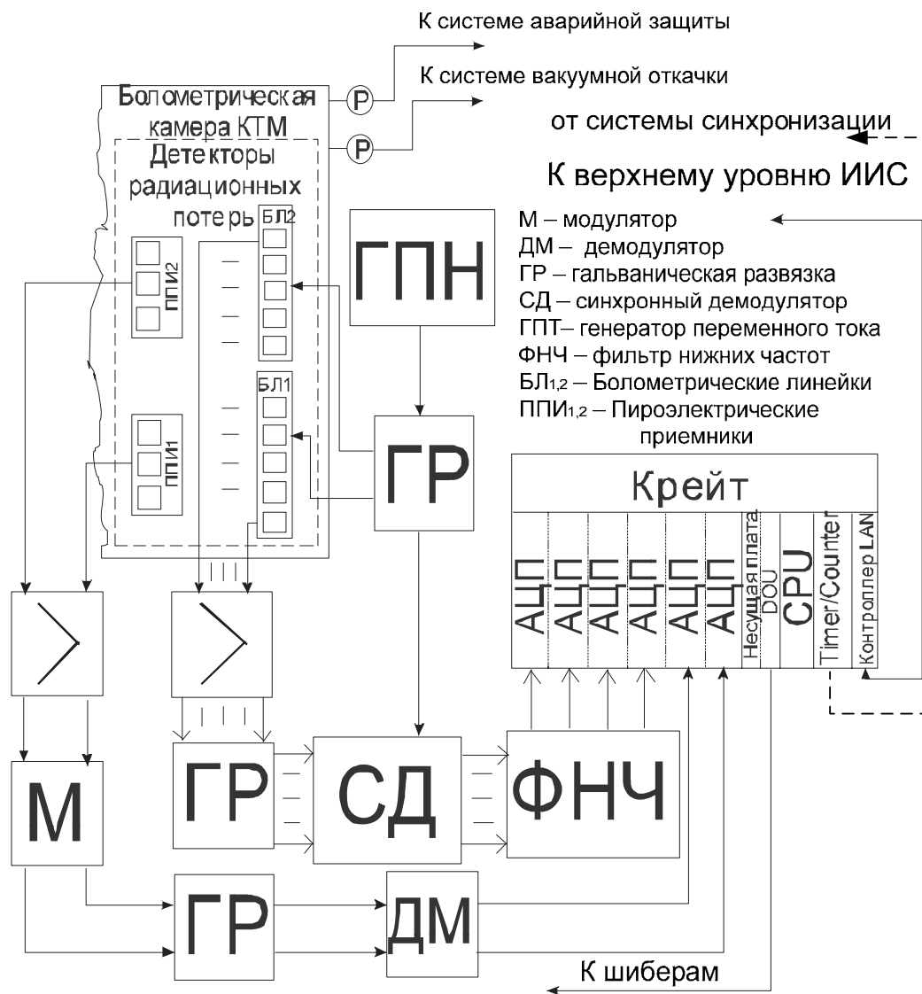
Рис. 8.2.9.1. Структурная схема ПСД многоканальной болометрии
