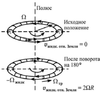
Рис. 2.13. Механический аналог явления электромагнитной индукции – трубка с жидкостью, поворачивающаяся на 180^\circ ; \Omega , \Omega_{\text{жидк}} , \Omega_{\text{тр}} – угловые скорости вращения Земли, жидкости, трубки
