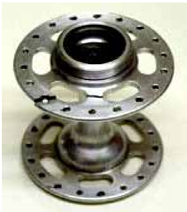
Рис. 1.1. Усталостное разрушение фланца втулки
