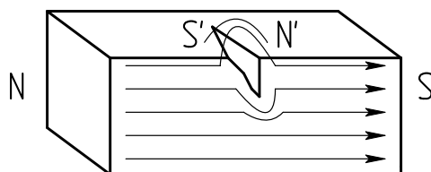
Рис. 2.3. Магнитное поле рассеяния над трещиной в постоянном магните. N и S – полюса магнита, N' и S' – магнитные полюса на гранях и на поверхности детали вблизи трещины
