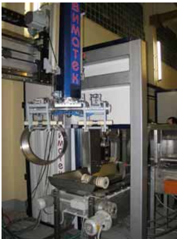
Рис. 3.21. Специализированная линия магнитопорошковой дефектоскопии фирмы «Виматек» ( www.vimatec.ru )
