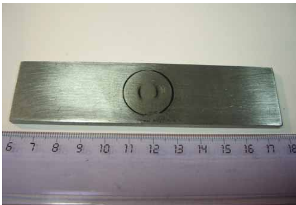
Рис. 4.14. Картина отложения магнитного порошка на контрольном образце для магнитной дефектоскопии с поверхностным и подповерхностным дефектом
