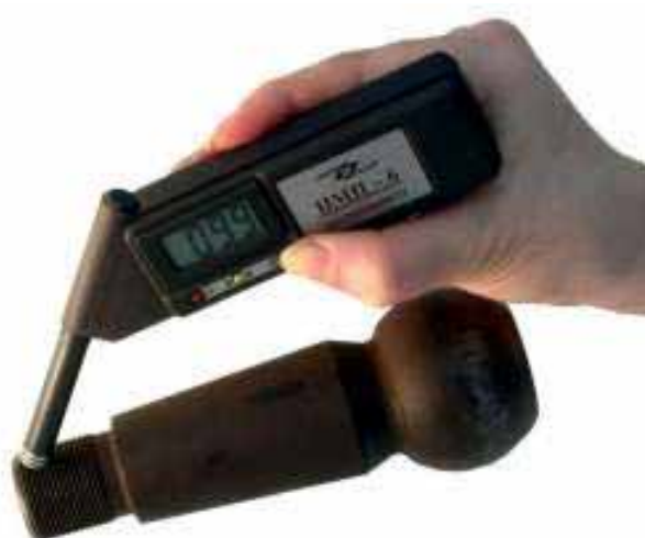
Рис. 4.2. Измеритель напряженности магнитного поля ИМП-6 ( www.labcentr.ru )
