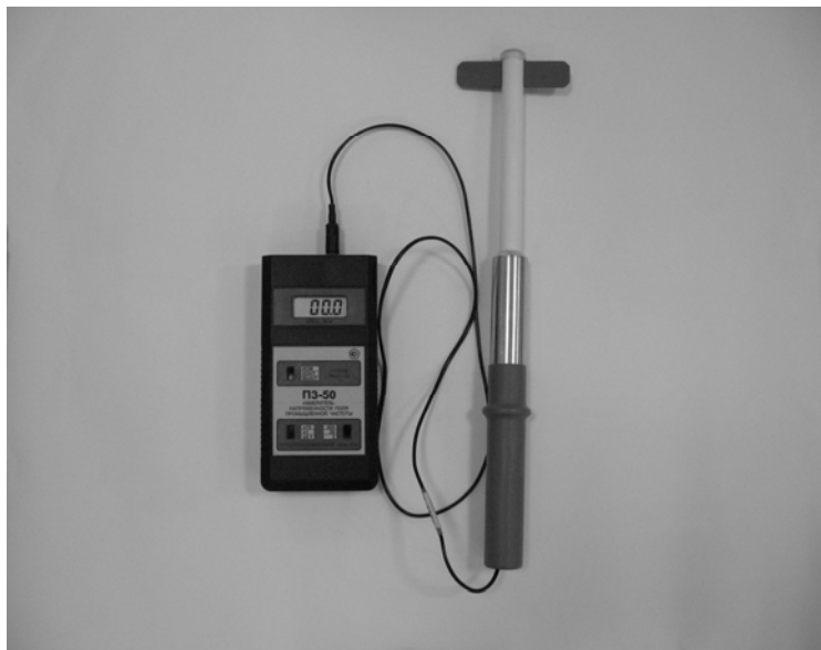
Рис. 1. Измеритель напряженности поля промышленной частоты с антенн-преобразователем ЕЗ-50
