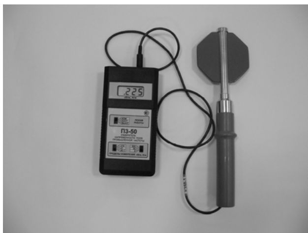
Рис. 3. Измеритель напряженности поля промышленной частоты с антенн-преобразователем НЗ-50
