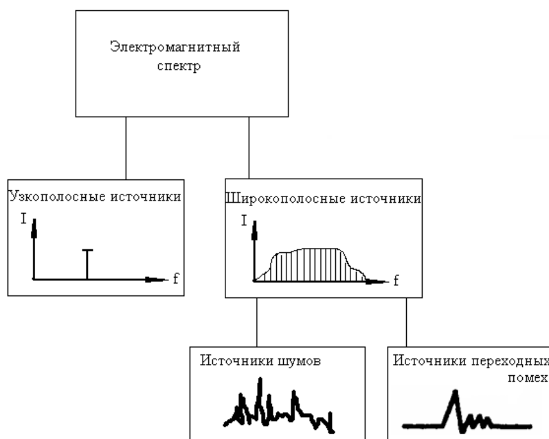
Рис. 2.1. Разделение передатчиков электромагнитной энергии на узкополосные и широкополосные источники
