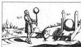
Электростатическая машина Отто фон Герике
