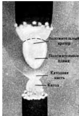
Рис. 7.26. Дуга при нормальном давлении
