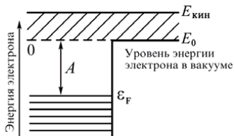
Рис. 7.32. Выход электронов в вакуум: E_F – энергия Ферми; E_0 – уровень энергии электрона, покоящегося в вакууме; A – работа выхода; E_{кин} – кинетическая энергия электрона в непрерывном спектре свободных состояний
