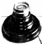
Настольный компас Эрстеда, на котором он наблюдал отклонение стрелки при включении и выключении электрического тока
