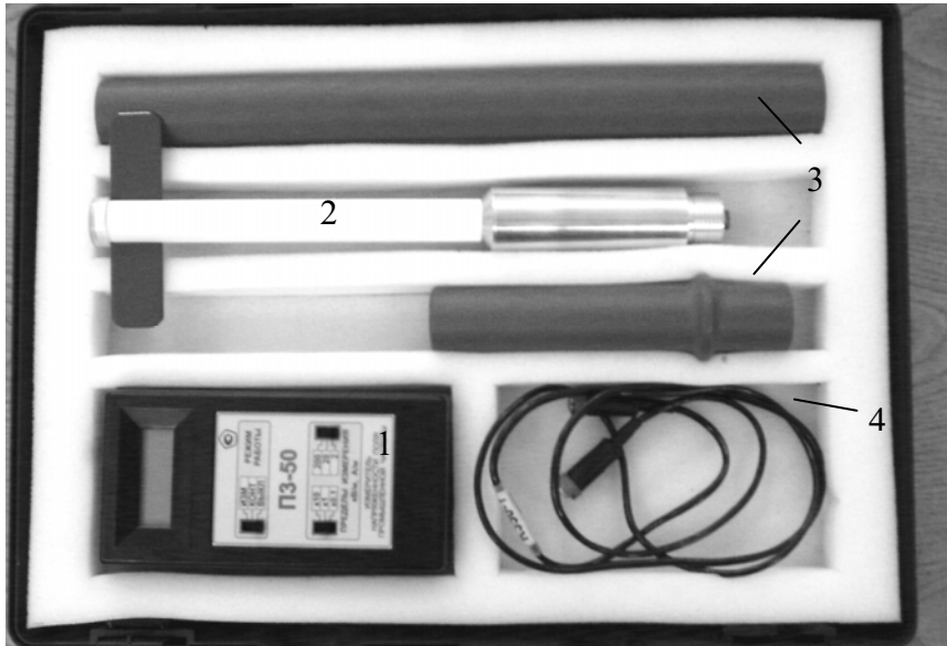
Рис. 2 Внешний вид прибора ПЗ-50: 1 – устройство отсчетное УОЗ-50; 2 – антенна преобразователь ЕЗ-50; 3 – изоляционные ручки; 4 – соединительный кабель
