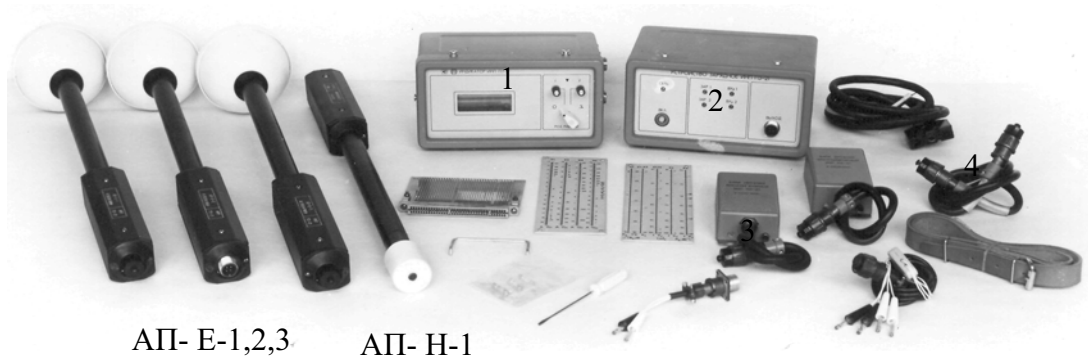
Рис. 20. Внешний вид измерителя напряженности поля ПЗ-21: 1 – Индикатор ИПН ПЗ-21; 2 – устройство зарядное, 3 – блок питания аккумуляторный; 4 – соединительные кабели
