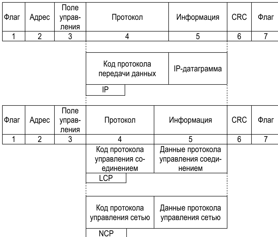
Рис. 45. Структура кадра протокола PPP
