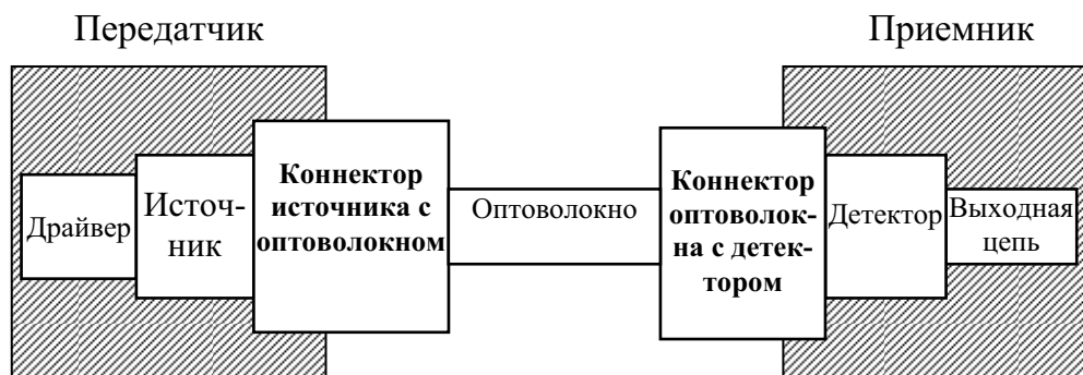
Рис. 5. Схема волоконно-оптического канала связи
