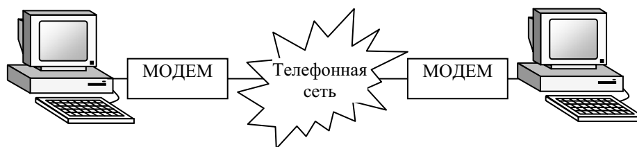
Рис. 41. Схема соединения компьютеров через телефонную сеть
