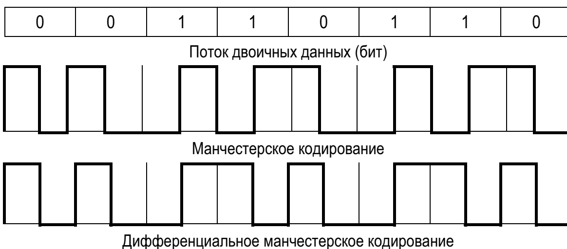
Рис. 20. Методы кодирования двоичных сигналов в локальной компьютерной сети
