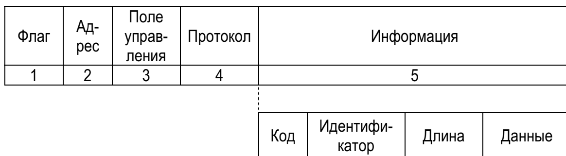
Рис.46. Структура пакета протокола управления соединением LCP
