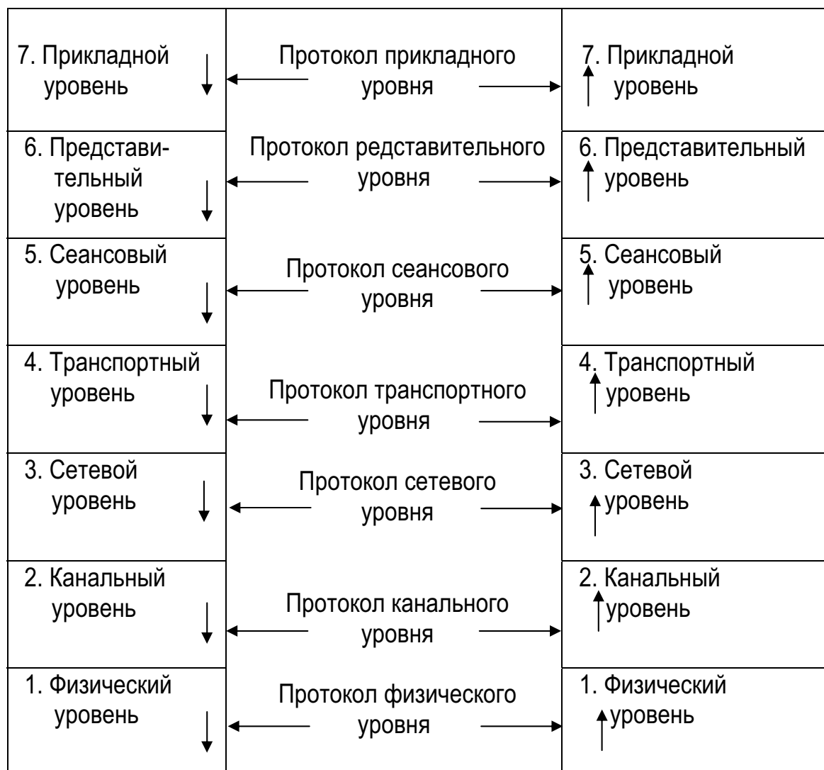
Рис. 17. Схема взаимодействия протоколов компьютерной сети модели ISO/OSI
