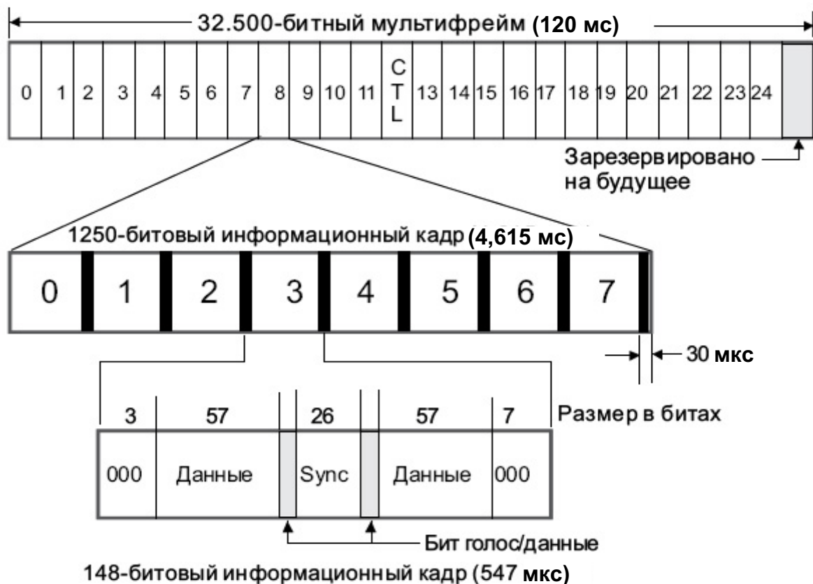
Рис. 73. Структура кадров в GSM
