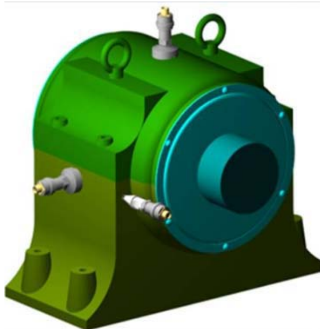
Рис. 24. Типичные контрольные точки измерений вибрации
