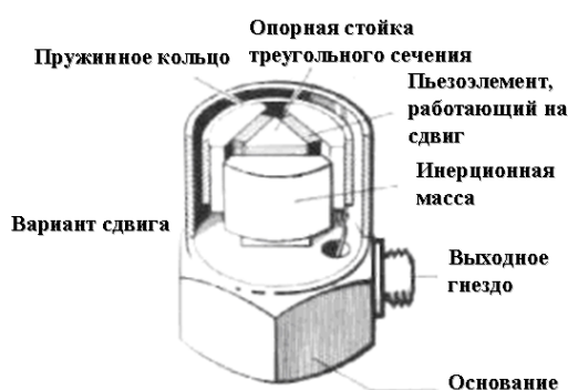
Рис. 45. Конструкция акселерометра с тремя пьезоэлементами, работающими под действием срезающей силы
