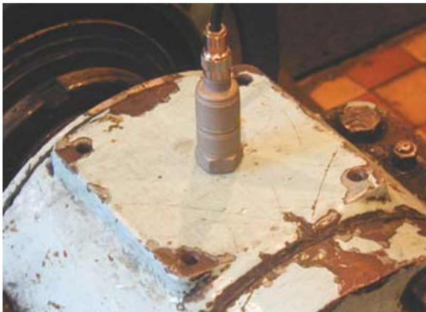
Рис. 34. Крепление вибродатчика при помощи шпильки
