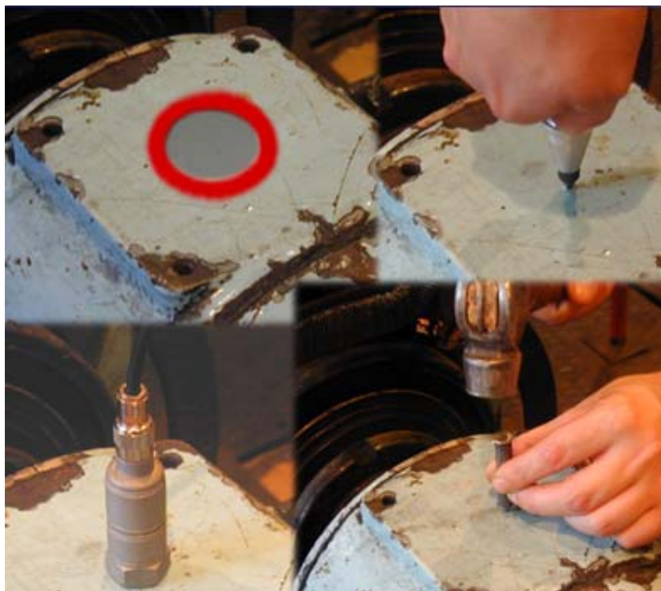
Рис. 33. Примеры подготовки поверхности для крепления на ней вибродатчиков
