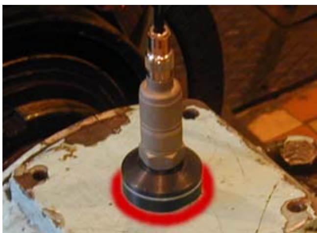
Рис. 35. Крепление вибродатчика при помощи магнита
