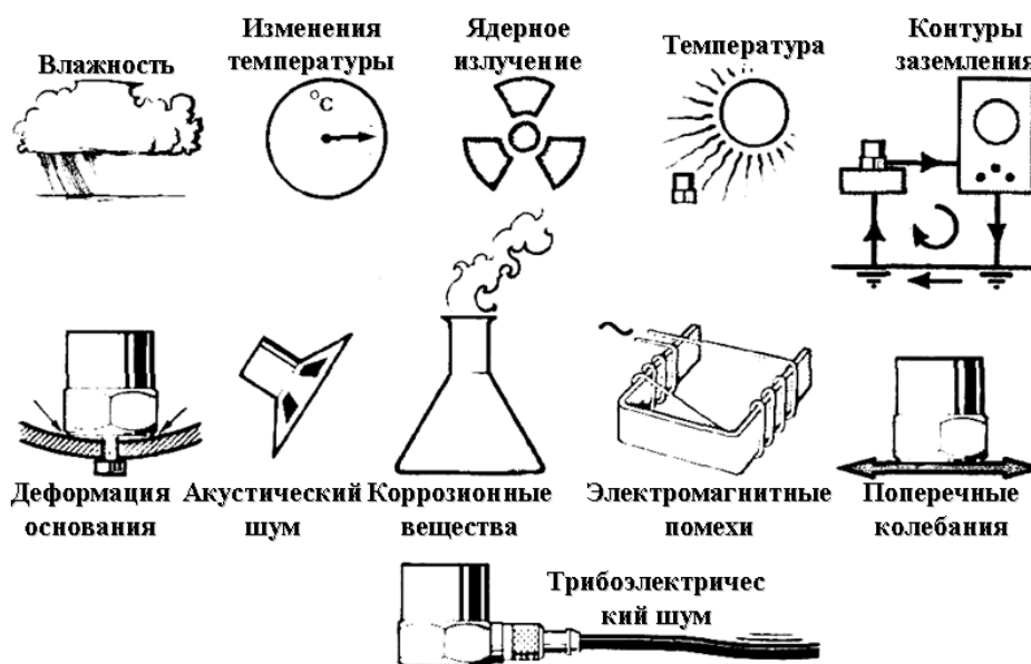
Рис. 54. Примеры влияния условий внешней среды на работу акселерометра
