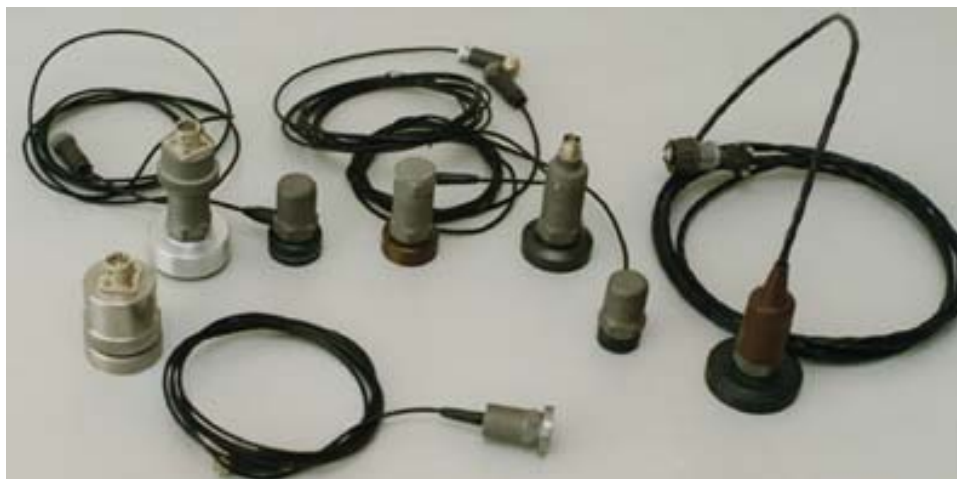
Рис. 30. Примеры исполнения вибродатчиков
