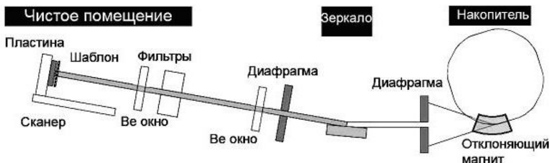
Рис. 11.8. Схема канала для глубокой рентгеновской литографии созданного на специализированном источнике СИ «АНКА»
