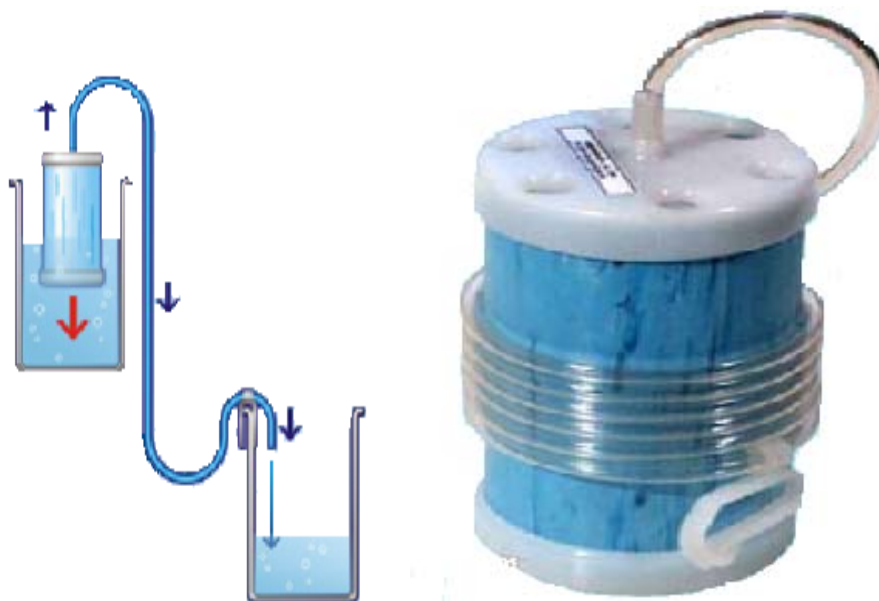
Рис. 10.10. Схема фильтрации. Рис. 10.11. Внешний вид «Исток-01»
