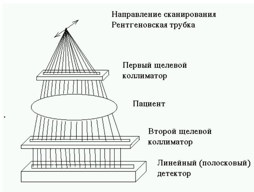
Рис. 9.6. Система линейного сканирования для цифровой рентгенографии грудной клетки
