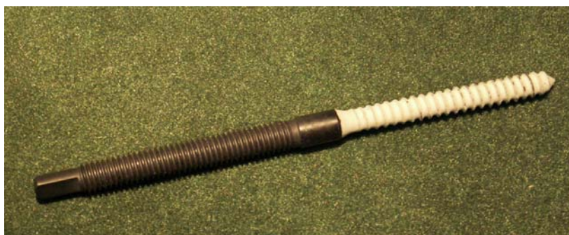
Рис. 5.3. Имплантат с покрытием, нанесенным по шликерной технологии
