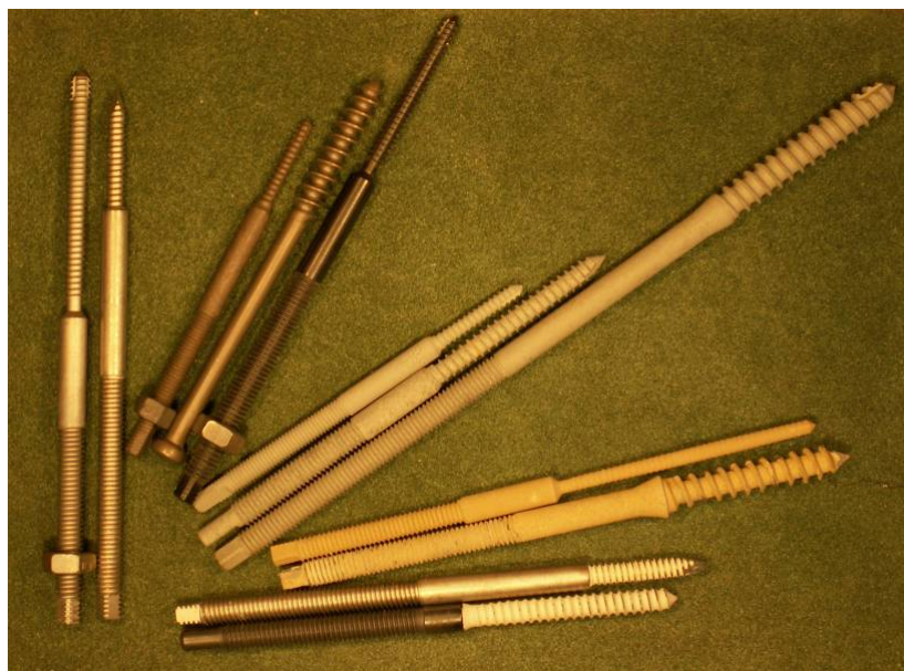
Рис. 5.4. Имплантаты с покрытием, содержащим соединения титана, кальция и фосфора [32–33]
