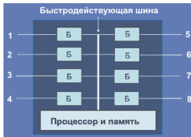
Рис. 37 Схема 8-входового сетевого коммутатора
