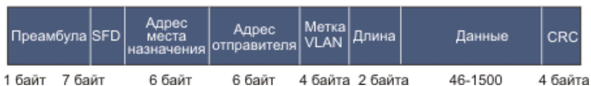
Рис. 42. Формат кадра уровня L2 в случае использования протокола 802.3ac
