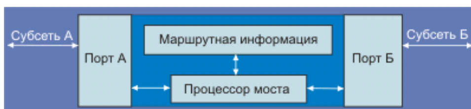
Рис. 34. Схема сетевого моста
