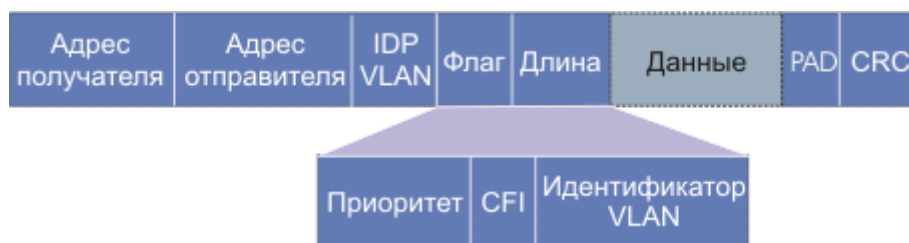
Рис. 43. Формат кадра протокола 802.1q
