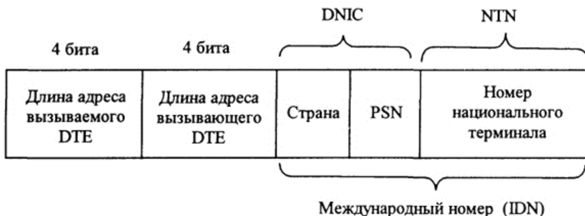
Рис. 28. Формат адреса X.121
