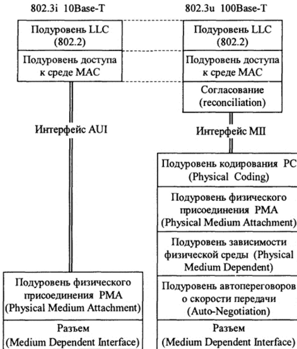
Рис. 22. Отличия стека протоколов 100Base-T от стека протоколов 10Base-T
