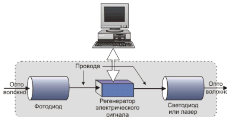
Рис. 16. Промежуточный волоконный усилитель
