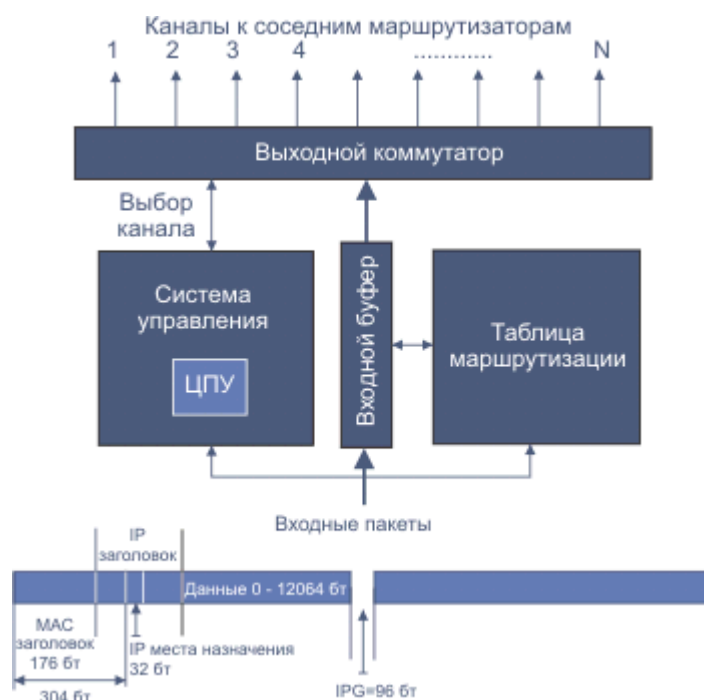
Рис. 40. Схема обработки пакетов в маршрутизаторе
