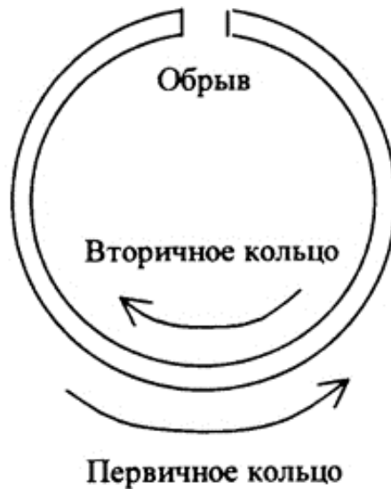
Рис. 24. Сворачивание колец FDDI в случае обрыва
