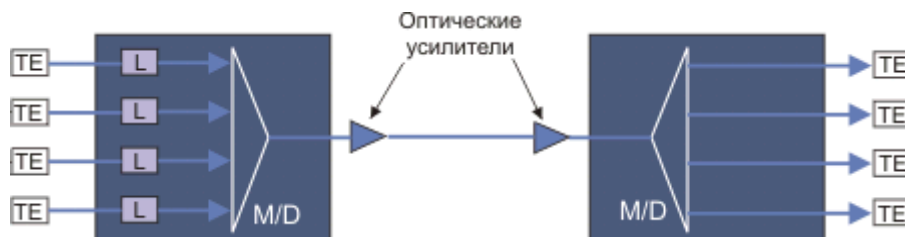
Рис. 18. Схема многоканального мультиплексирования с делением по длине волны в оптическом волокне.
