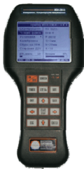
Рис. 9.17. Измеритель концентрации напряжений ИКН-1М-4
