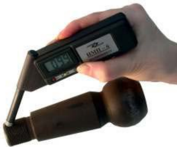
Рис. 4.2. Измеритель напряженности магнитного поля ИМП-6 ( www.labcentr.ru )
