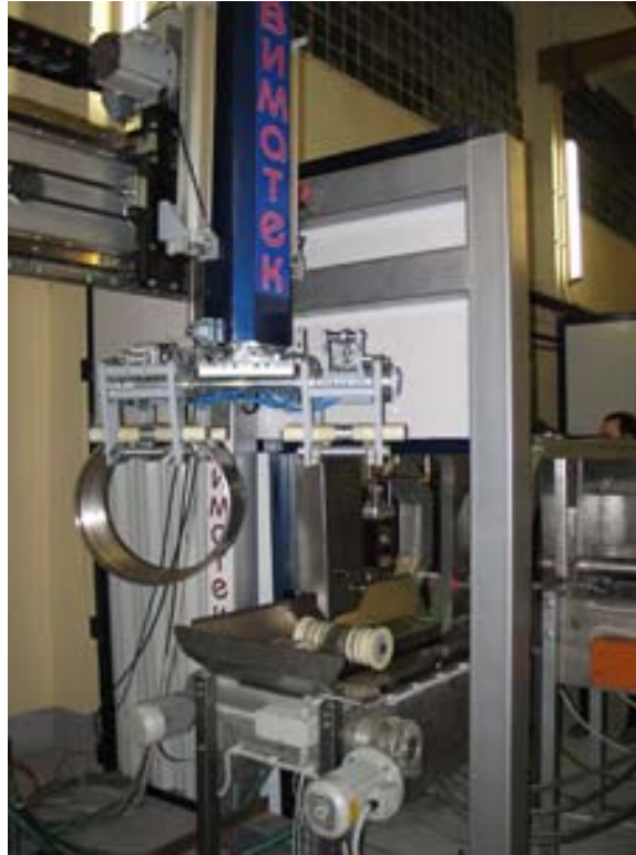
Рис. 3.21. Специализированная линия магнитопорошковой дефектоскопии фирмы «Виматек» ( www.vimatec.ru )
