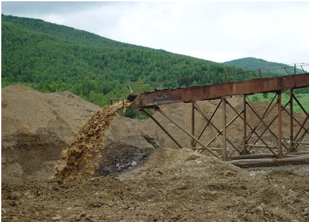
Fig. 28. Discharge of used «sands» from the washout unit
