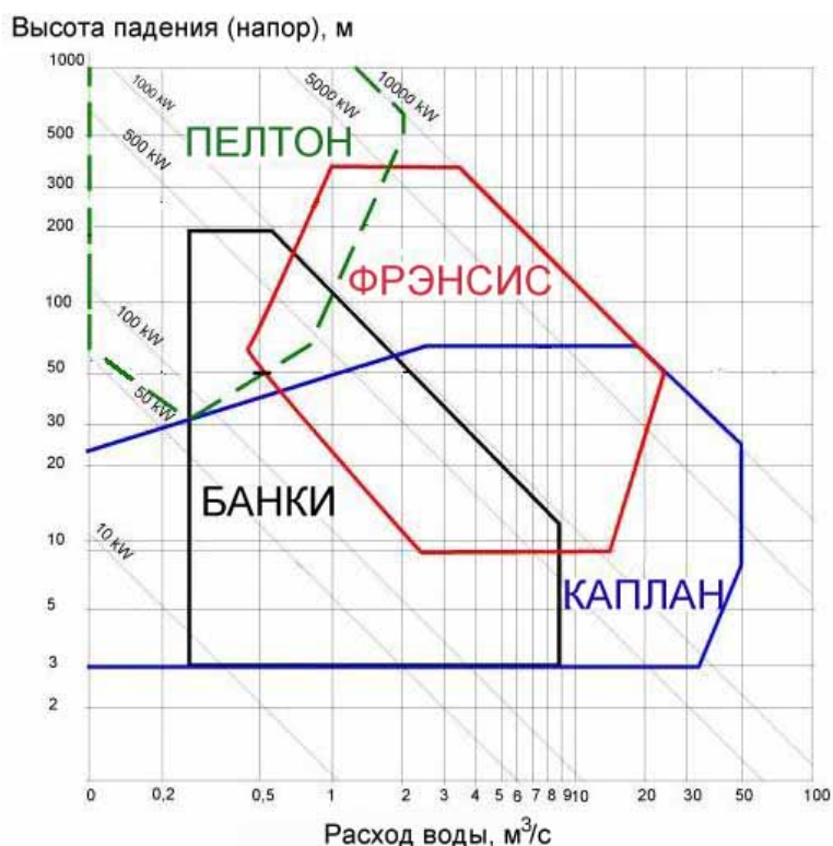
Рис. 4.29. Зоны работы гидротурбин микроГЭС
