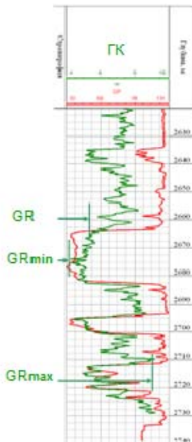
Рис. 42. Определение глинистости по данным гамма каротажа
