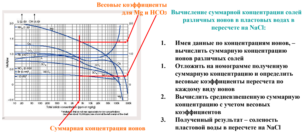
Рис. 28. Схема пересчета концентраций солей в эквивалентное содержание NaCl
