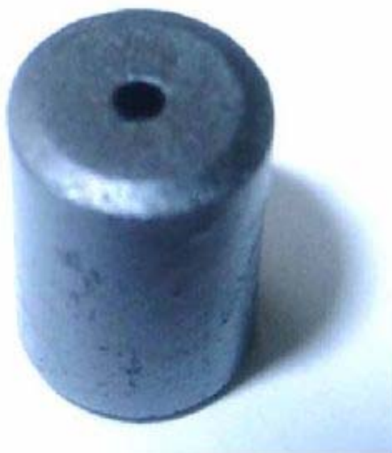
Рис. 7.1. Спеченная топливная таблетка ТВЭЛа для ВВЭР
