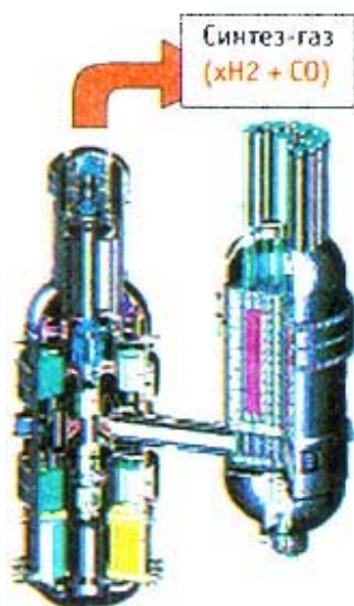
Рис. 1.1. Модульный гелиевый реактор с паровой конверсией метана
