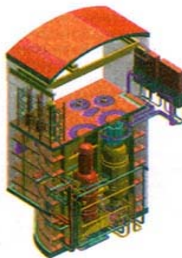
Рис. 1.2. Компоновка модульного гелиевого реактора в здании
