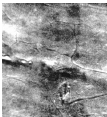
Рис. 4.43 а. Поверхность образца нержавеющей стали насыщенного водородом. Время насыщения 4,5 часа, плотность тока 1 А/см 2 . РЭМ. Увеличение 1500
