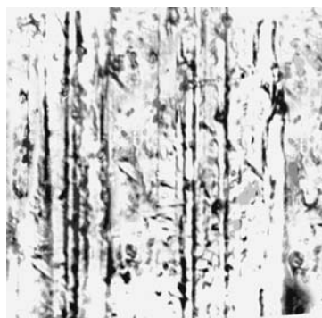
Рис. 4.36. Исходная поверхность титана VT1-0. Обработка: механическая полировка, отжиг в вакууме. Металлография, увеличение 1000
