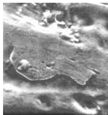
Рис. 4.43 б. Поверхность образца нержавеющей стали, насыщенного водородом. Время насыщения 4,5 часа, плотность тока 1 А/см 2 . РЭМ. Увеличение 150
