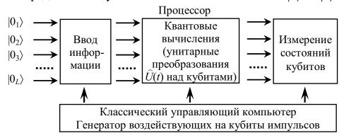
Рис. 3.32. Схематическая структура квантового компьютера
