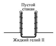
Рис. 6.18. Стрелками показана поверхностная плёнка жидкого гелия II, перетекающая в пустой сосуд. Поверхность действует как сифон
