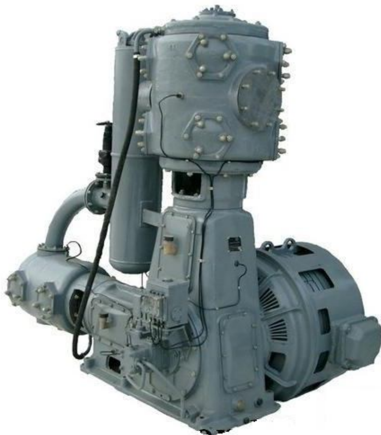
Рис. 2.10. Общий вид поршневого компрессора типа П
