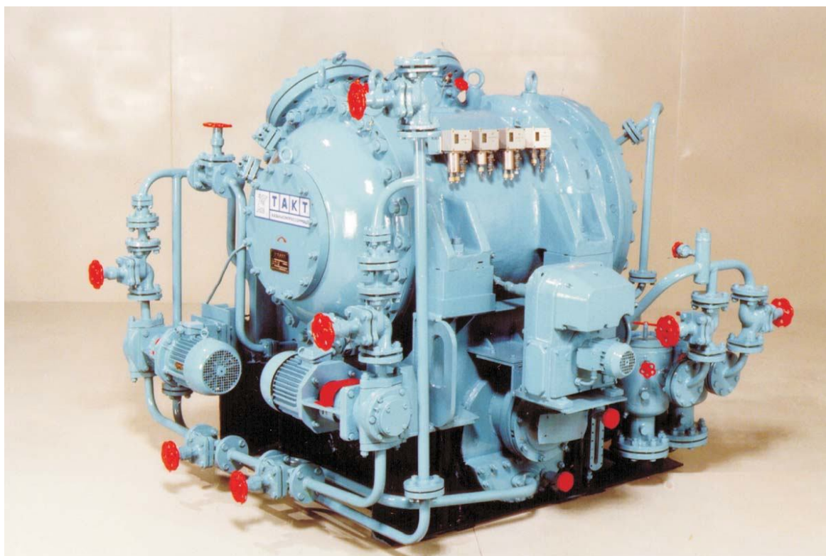
Рис. 2.16. Компрессорный агрегат турбохолодильной машины 10TXMB-2000- 2 с вертикальным разъемом корпуса образца 1985 г.
