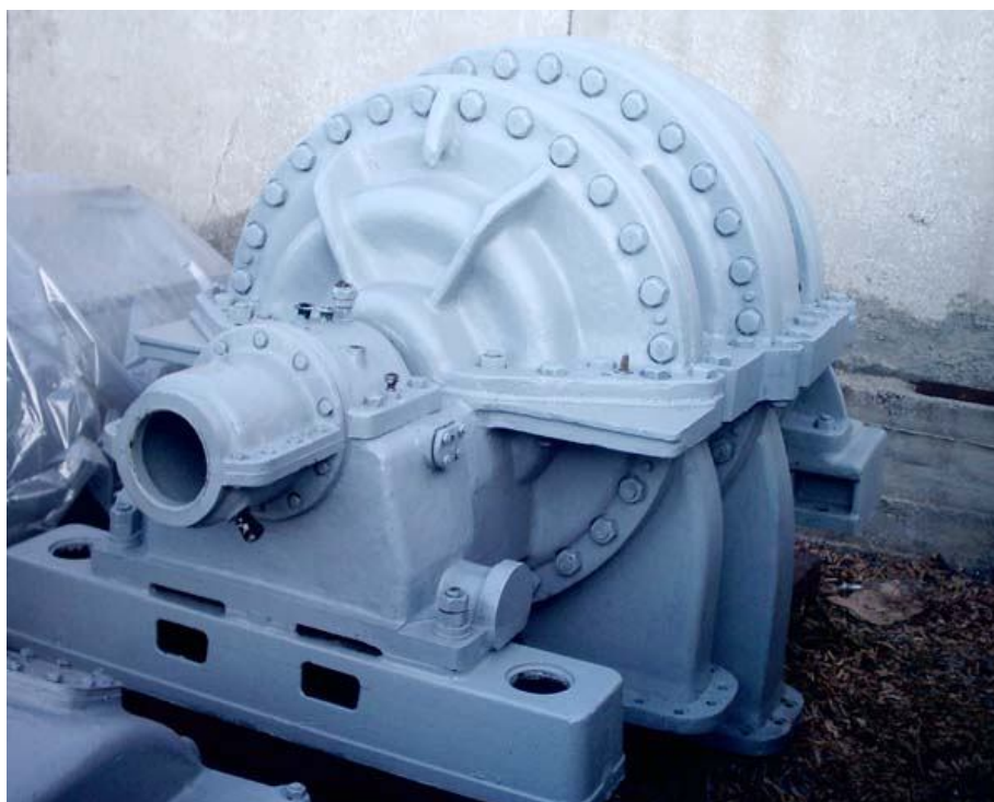
Рис. 2.11. Общий вид турбокомпрессора К-250-61-5
