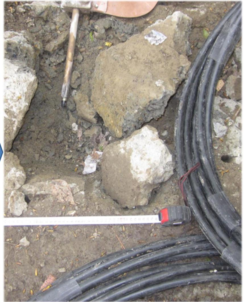
Откол от залитого в землю модельного образца бетона, марки В-22, размерами 1000x1000x2000
