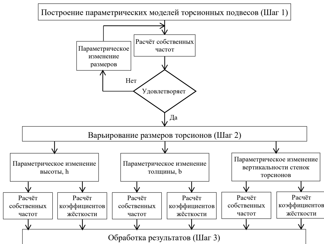
Рисунок 3.7 – Алгоритм анализа влияния типовых дефектов торсионных подвесов
