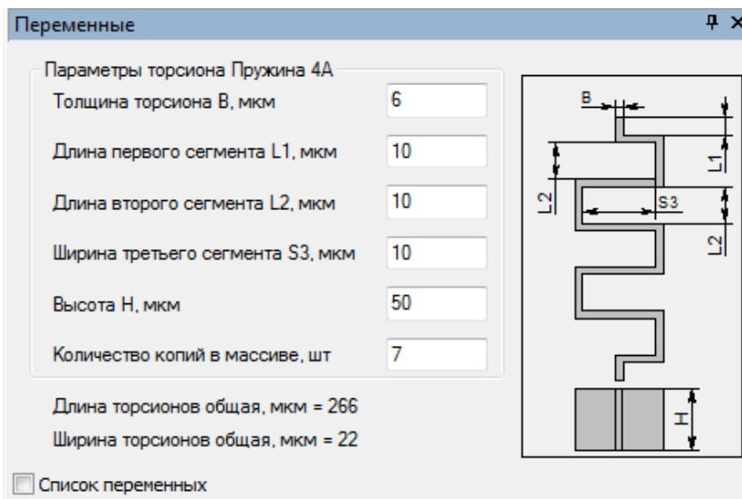
Рисунок 3.4 – Диалоговое окно геометрических параметров торсиона
