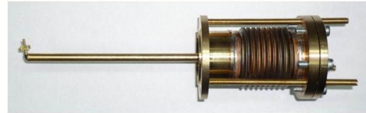
Инжектор позитронов без закрепленного источника
