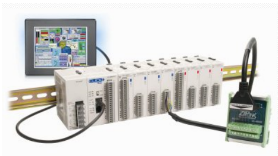
Рисунок 12. Организация расширенного ввода/вывода ПЛК на DIN-рейке
