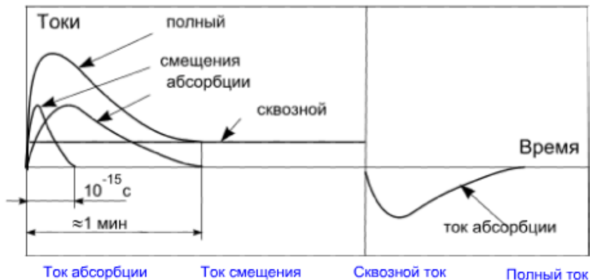
Временные зависимости токов для диэлектрика, в котором возникают токи абсорбции
