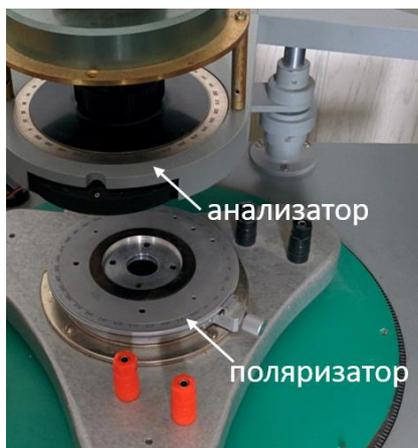
Рис. 11. Поляризационные приспособления для получения линейно поляризованного света
