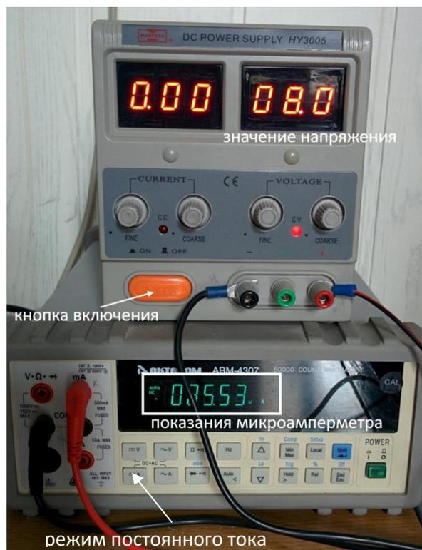
Рис. 10. Источник напряжения и амперметр, работающий в режиме измерения постоянного тока в микроамперах
