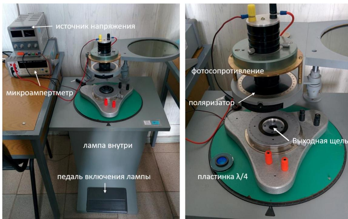
Рис. 9. Экспериментальная установка с обозначением основных элементов
