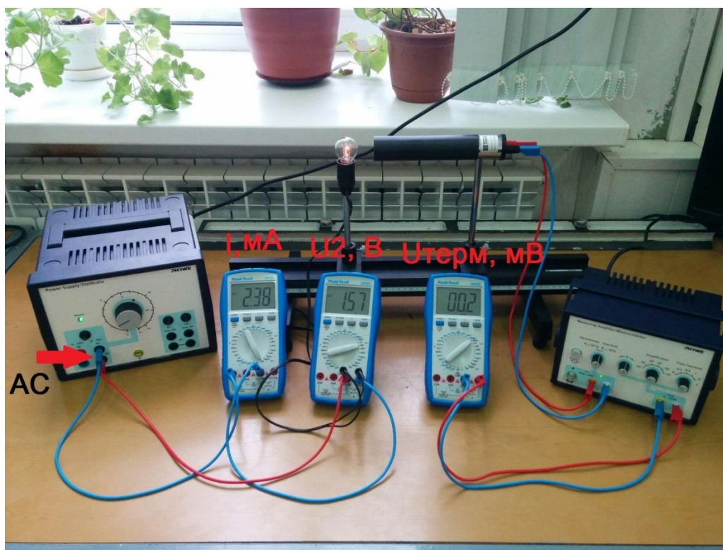
Рис. 4. Схема установки для проверки закона Стефана-Больцмана
