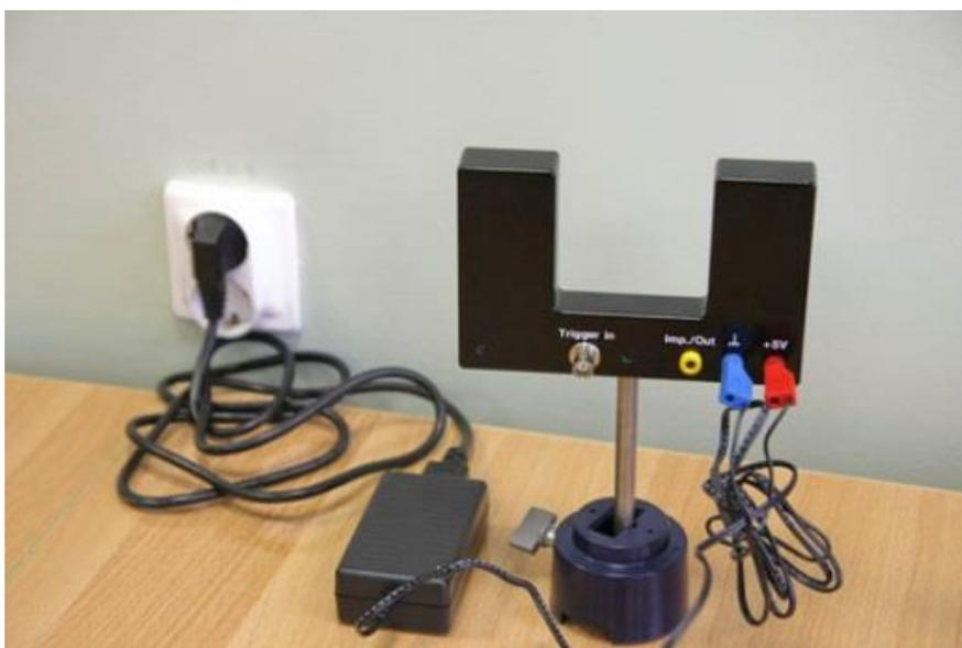
Рис. 7. Подключение светового барьера
