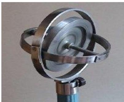
Рис. 1. Механический гироскоп в оправе «карданов подвес»
