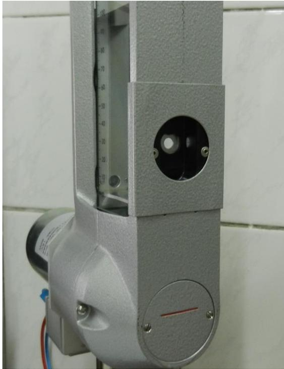
*Рис. 2.3 Крышка-фиксатор кюветы*
